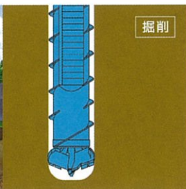
EGケーシングが壁面の崩壊を確実に防止。
