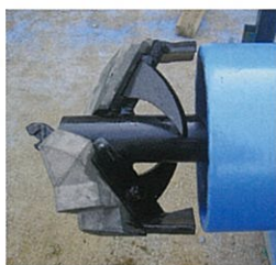
苦心の末に開発された掘削・締め固め両用のブレード
