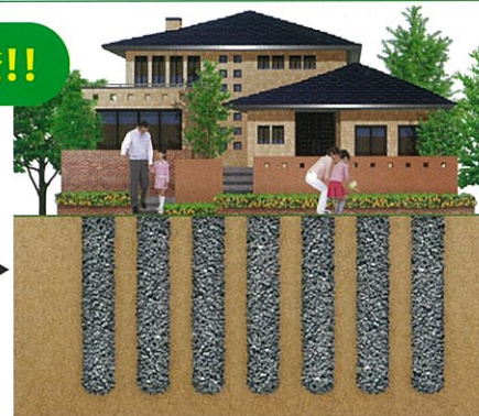
砕石だけを確実に締め固めることができるため、計画通りの支持力、透水性を確保。
