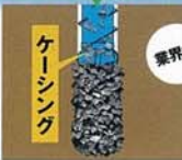
エコジオ工法の施工
