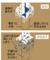
ケーシングを使用しない施工
