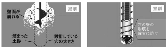
第12図 ケーシングで穴の崩壊を防ぐ
