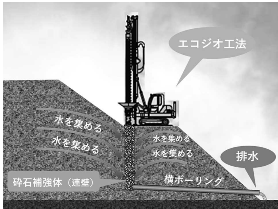
第6図 盛土排水対策の概念図
