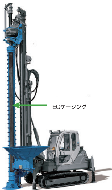
エコジオ地盤改良機
