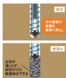
エコジオ工法の施工
